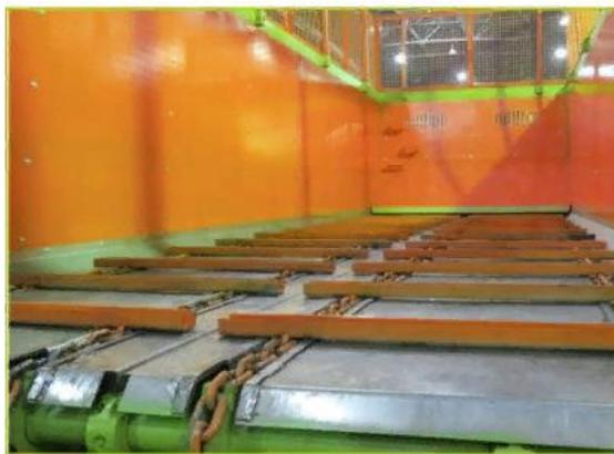
Рисунок 4.3 - Двухдорожечный транспортер
