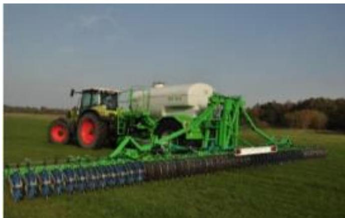
Рисунок 8.8 - Складная рама в рабочем положении
