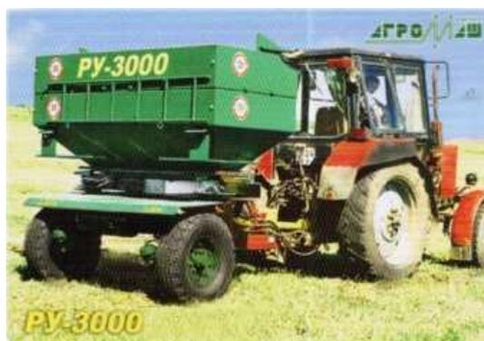
Рисунок 3.3 - Разбрасыватель минеральных удобрений PY-3000
