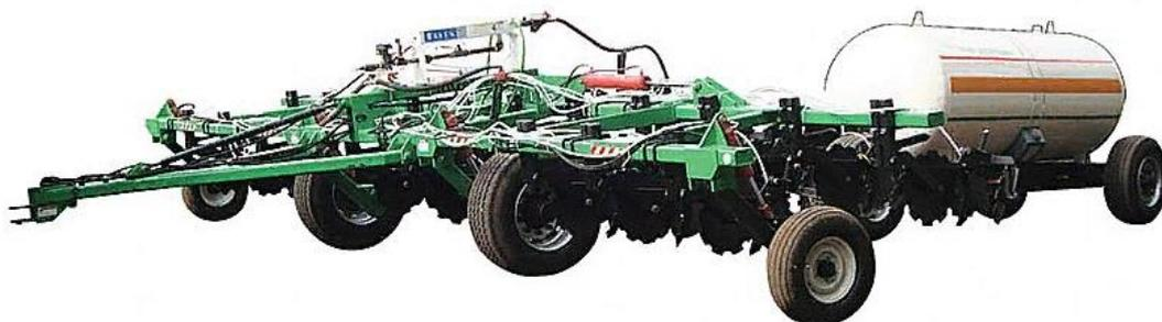
Рисунок 9.1 - Агрегат для внесения безводного аммиака (NitroMaster)
