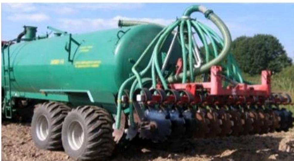
Рисунок 7.1 – Прицепная машина для внесения жидкого навоза МПВУ-16 с адаптером дисковым для подпочвенного внесения жидкого навоза
