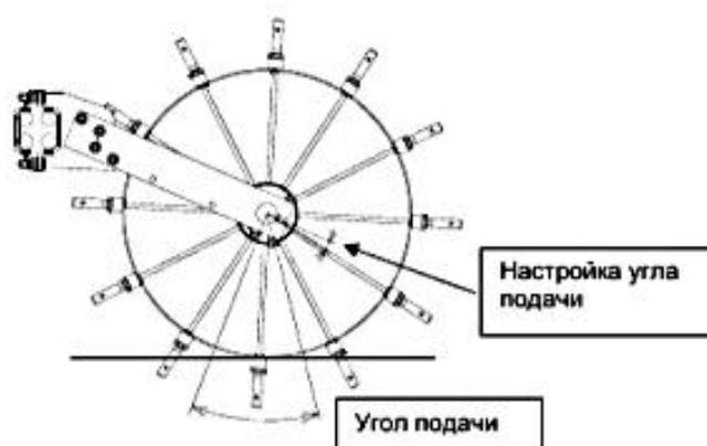
Рисунок 8.7 - Настройка угла подачи
