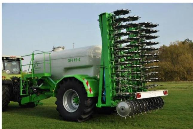
Рисунок 8.3 - Машина в транспортном положении
