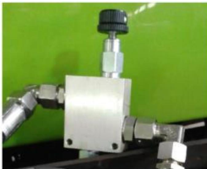
Рисунок 8.6 - Подъемный клапан
