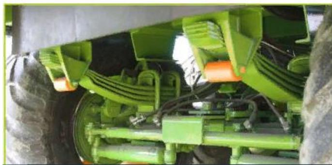
Рисунок 4.5 – Управляемые оси
