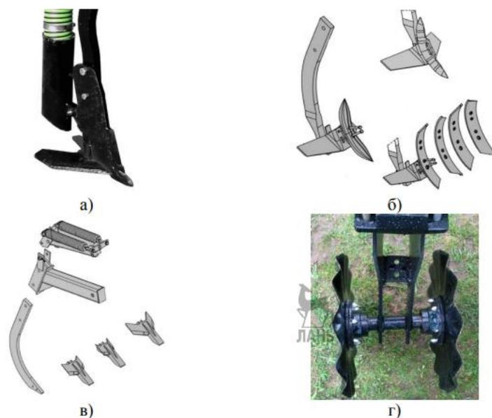
Рисунок 7.5 – Рабочие органы для внутрипочвенного внесения жидких органических удобрений
