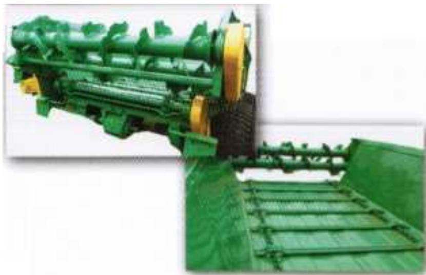
Рисунок 5.2 – Рабочие органы машины ПРТ-7А
