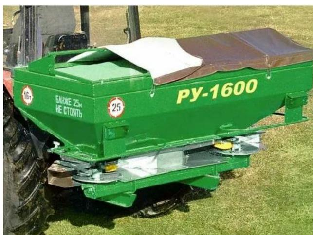
Рисунок 3.2 - Рассеиватель минеральных удобрений PY-1600
