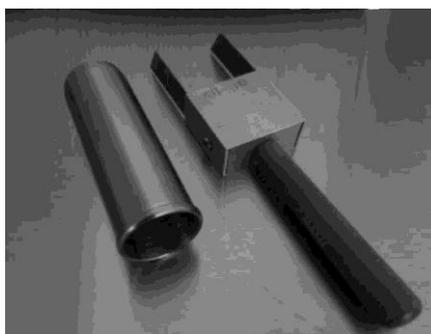
Рис. 2. Пробник Журавлева для определения пористости хлеба (детали прибора)
