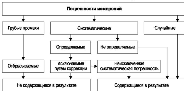
Рис. 5.2. Классификация погрешностей измерений по характеру их проявления
