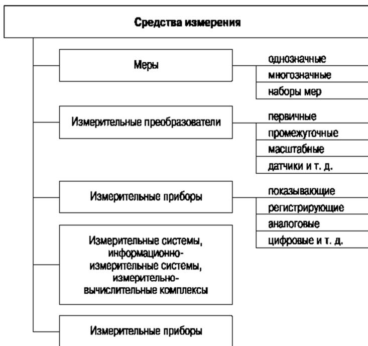
Рис. 5.1. Классификация средств измерения по роли в процессе измерения и выполняемым функциям
