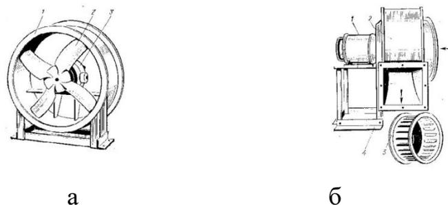
а - осевой вентилятор: 1 - корпус; 2 - крылатка; 3 - электродвигатель.
