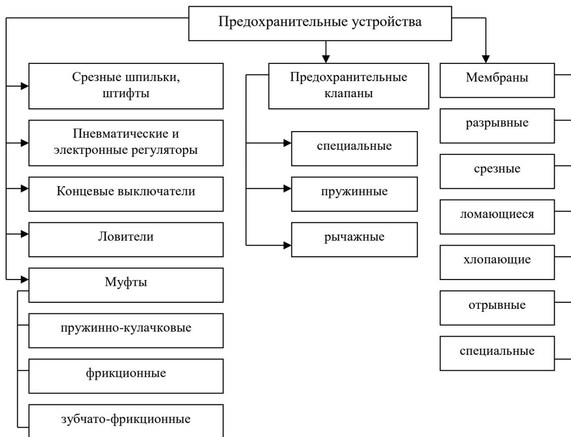
Рисунок 7.4 – Классификация предохранительных устройств
