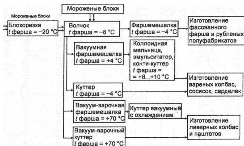
Рис. 1. Технологическая схема использования замороженного блочного сырья для производства различных видов мясopодуkтов
