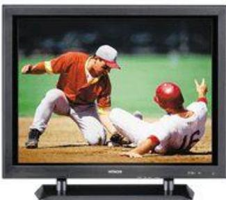
*Газоплазменные мониторы* состоят из двух пластин, между которыми находится газовая смесь, светящаяся под воздействием электрических импульсов.
