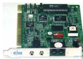
Цифровые данные, поступающие в модем из компьютера, преобразуются в нем путем модуляции (по амплитуде, частоте, фазе) в соответствии с избранным стандартом (протоколом) и направляются в телефонную линию. Модем-приемник, понимающий данный протокол, осуществляет обратное преобразование (демодуляцию) и пересылает восстановленные цифровые данные в свой компьютер. Таким образом обеспечивается удаленная связь между компьютерами и обмен данными между ними.
