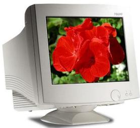
Изображение получается в результате облучения люминофорного покрытия остронаправленным пучком электронов, разогнанных в вакуумной колбе.
