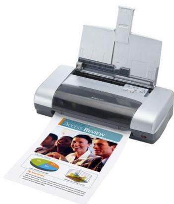
В струйных печатающих устройствах изображение на бумаге формируется из пятен, образующихся при попадании капель красителя на бумагу. Выброс микрокапель красителя происходит под давлением, которое развивается в печатающей головке за счет парообразования. В некоторых моделях капля выбрасывается щелчком в результате пьезоэлектрического эффекта – этот метод позволяет обеспечить более стабильную форму капли, близкую к сферической.
