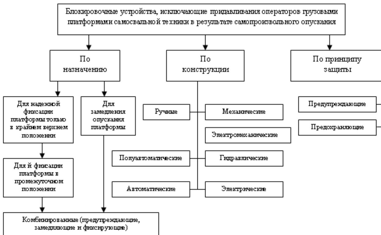
Рисунок 117 – Классификация технических средств безопасности грузовых самосвальных платформ
