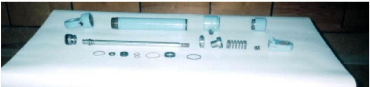
Рисунок 154 – Модель силового гидроцилиндра в разборном виде
