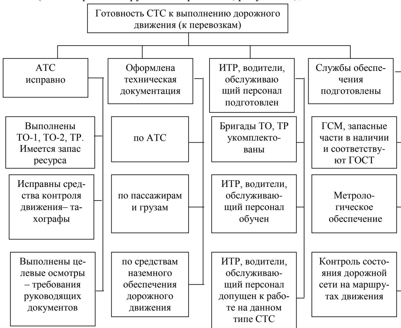
Рисунок 49 – Схема подготовки СТС к выполнению транспортных процессов
