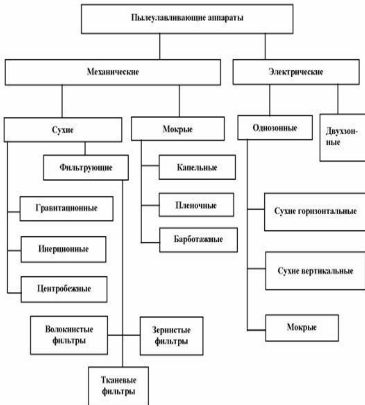
Рисунок 3 – Классификация пылеулавливающих аппаратов
