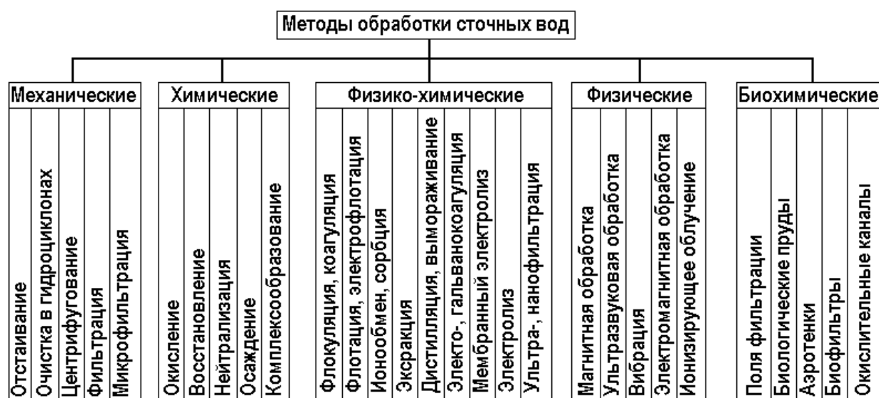
Рисунок 3 – Классификация основных методов обеззараживания сточных вод
