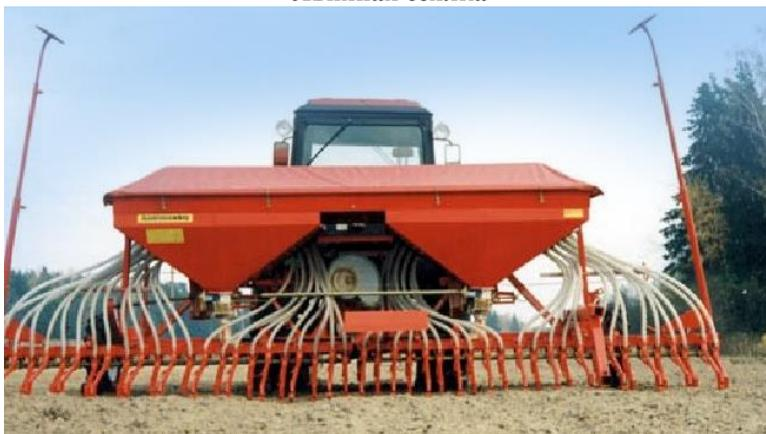
Сеялка СПУ-6Л предназначена для рядового посева льна. В зависимости от высеваемой культуры норму высева можно изменять от 1,8 до 400 кг/га и глубину заделки семян в пределах требований к каждой культуре.
