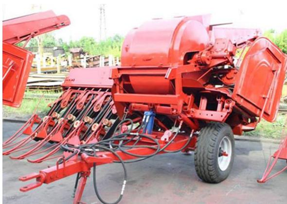
Комбайн льноуборочный ЛЕН-4М предназначен для те-ребления льна долгунца. Агрегатируется комбайн с тракторами класса 1,4.
