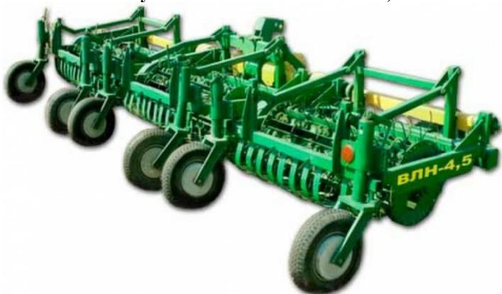
Вспушиватель лент льна ВЛН-4,5 выполняет отрыв лент льна от льнища, чем обеспечивается улучшение условий вылежки, исключение вероятности подгнивания нижнего слоя и ускорение их просыхания перед прессованием в рулон пресс-подборщиком. Агрегатрируется вспушиватель лент льна ВЛН-4,5 с тракторами тягового класса 1,4. Способ агрегатирования – навесной.
