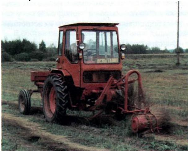
Предназначен для переворачивания разостланных льноуборочным комбайном лент льносолумы в процессе вылежки в тресту с целью сохранения ее качества, а также лент тресты перед уборкой для ускорения ее естественной сушки.
