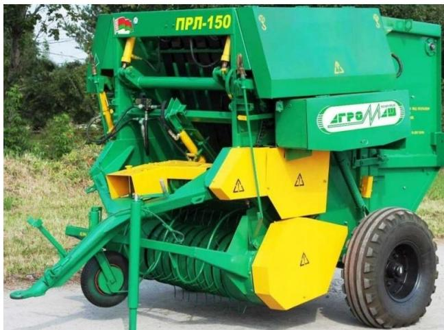
Пресс-подборщик рулонный ременный ПРЛ-150 (для уборки льна) с переменной камерой прессования открытого типа предназначен для выполнения операций по подбору лент льностресты, одновременно формируя равномерный слой льна в рулонах и обматывая произведённые рулоны шпагатом. При формировании рулона выполняется прокладывание каждого слоя льна двумя нитями шпагата.
