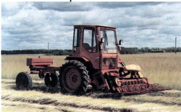
Навесная, прямоточная, предназначена для теребления льна при раздельной и комбайновой (подготовка проходов) технологичных уборки.
