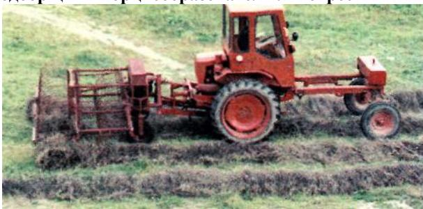
Навесной, с приводом рабочих органов от ВОМ трактора Т-25 или переоборудованного шасси Т-16МГ. Предназначен для подбора лент льна и сбрасывания их в виде порций.
