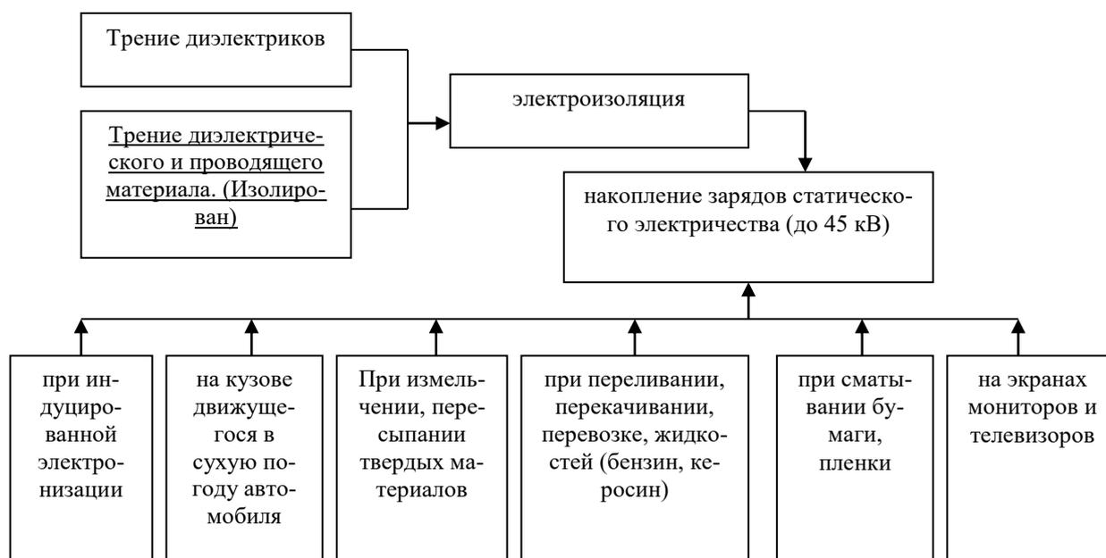
Рисунок 54 - Образование заряда статического электричества
