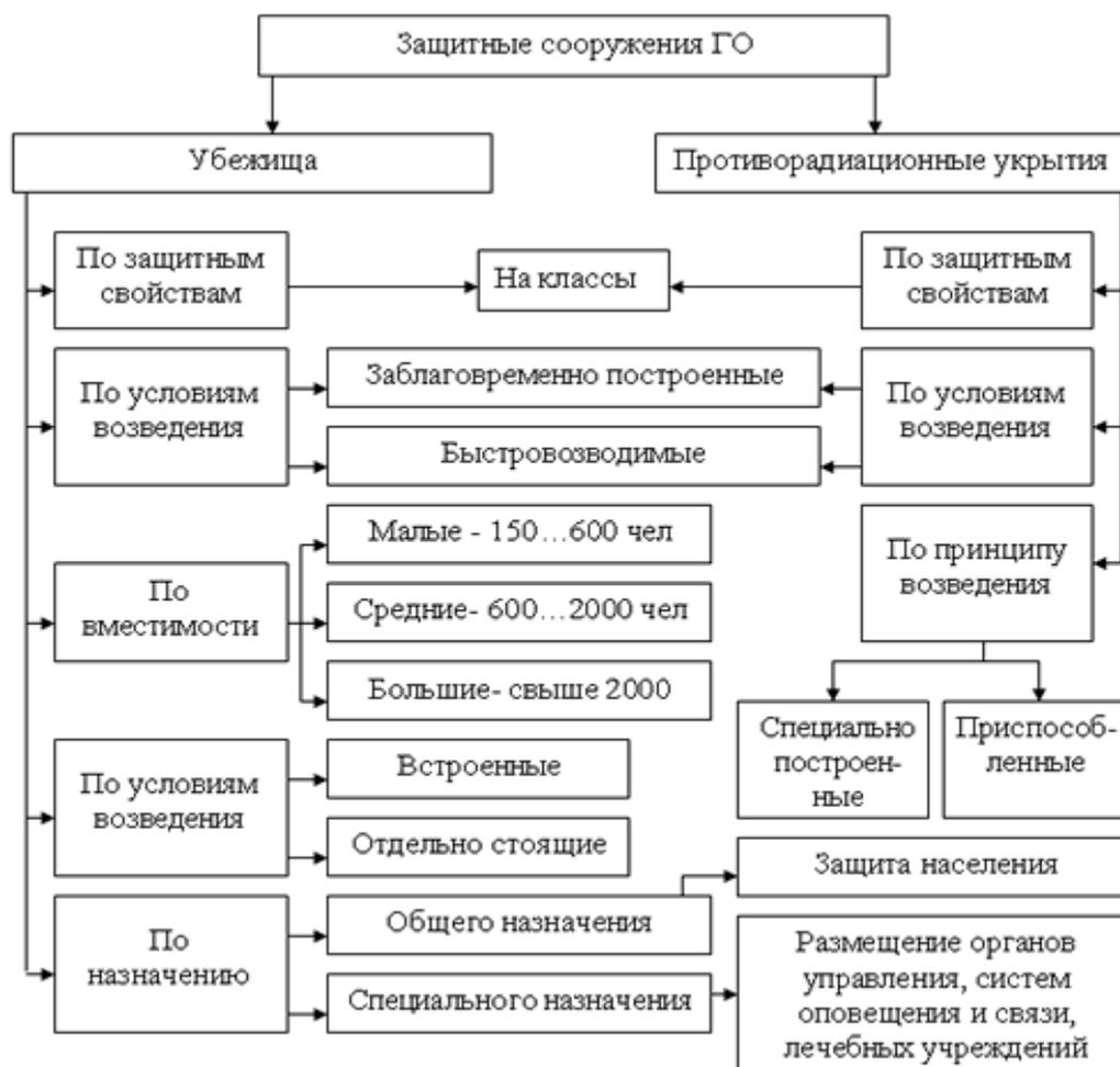
Рисунок 34 - Классификация защитных сооружений
