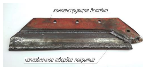
Рисунок 4 – Восстановленный и упрочненный остов составного лемеха компании «Фогель и Ноот» (а - лицевая сторона; б – тыльная сторона)
