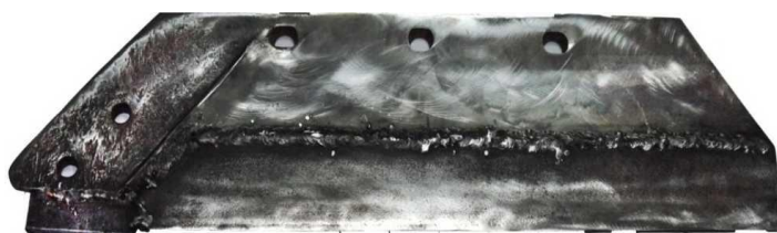
Рисунок 1 - Восстановленный лемех с вваренной вставкой (режущая часть)
