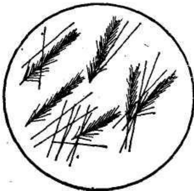
Иглообразные кристаллы \text{CaSO}_4 \cdot 2\text{H}_2\text{O}
