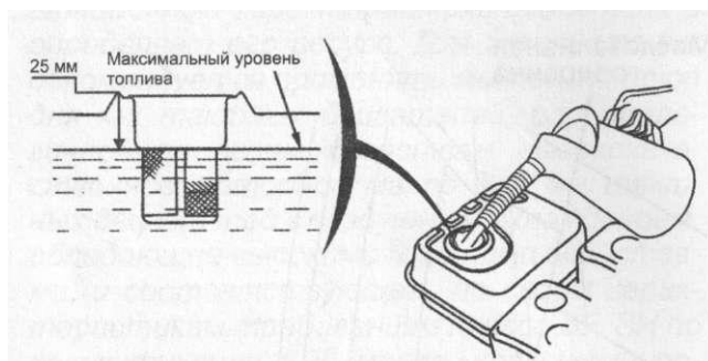
Рисунок 17 – Проверка уровня топлива
