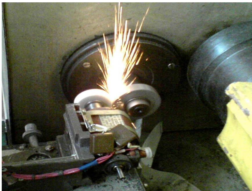
Рисунок 2. Шлифовальное устройство к машине трения 2070 СМТ-1.
