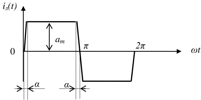
Рисунок 3. Параметры аппроксимированной трапециевидной кривой тока  $i_n(t)$ :  $a_m$  – амплитудное значение кривой  $i_n(t)$ ;  $\alpha = \pi/12$
