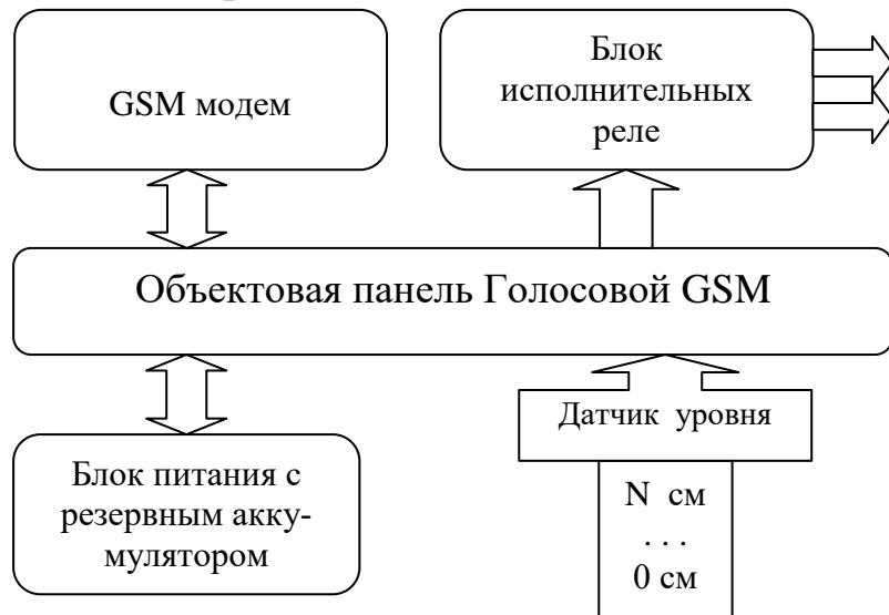
Рис. 1. Структурная схема ACK (автоматизированная система контроля).
