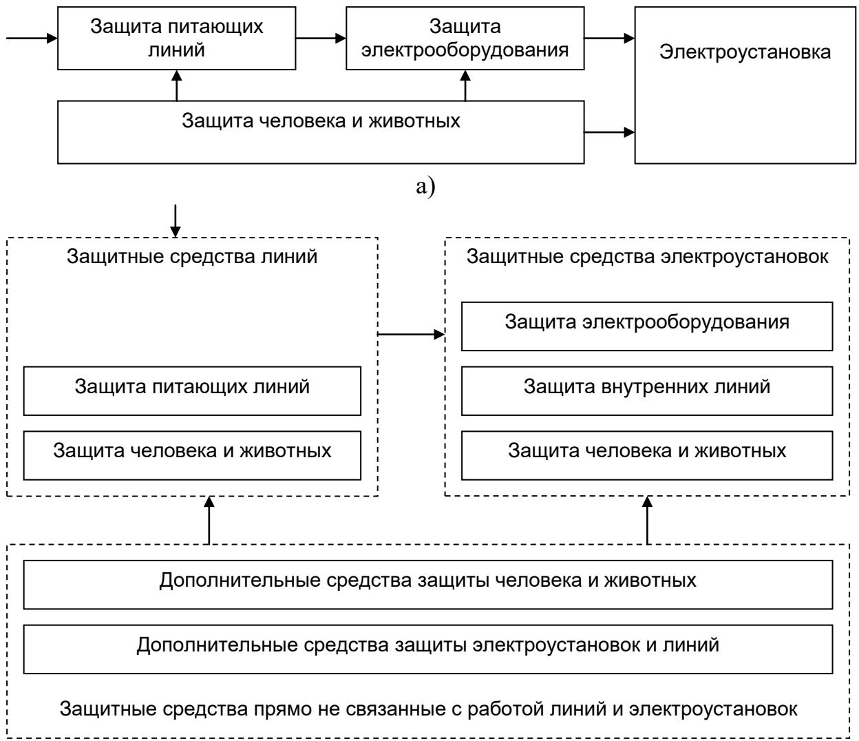
Рисунок 1. Система защит производственного помещения (а) и обобщенная структура защит производственного помещения (б)
