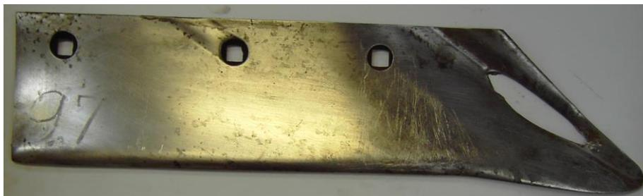
Рисунок 1.9 – Лучевидный износ, осложненный сквозным протиранием лемеха
