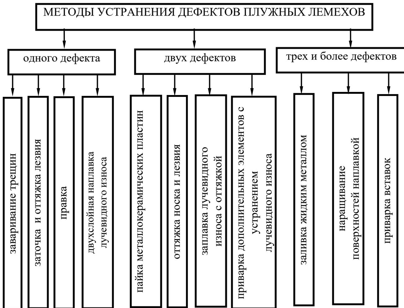
Рисунок 1.26 – Схема методов устранения дефектов плужных лемехов
