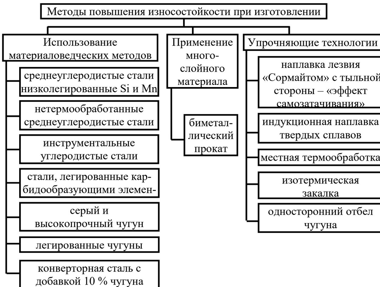
Рисунок 1.1 – Методы повышения износостойкости при изготовлении
