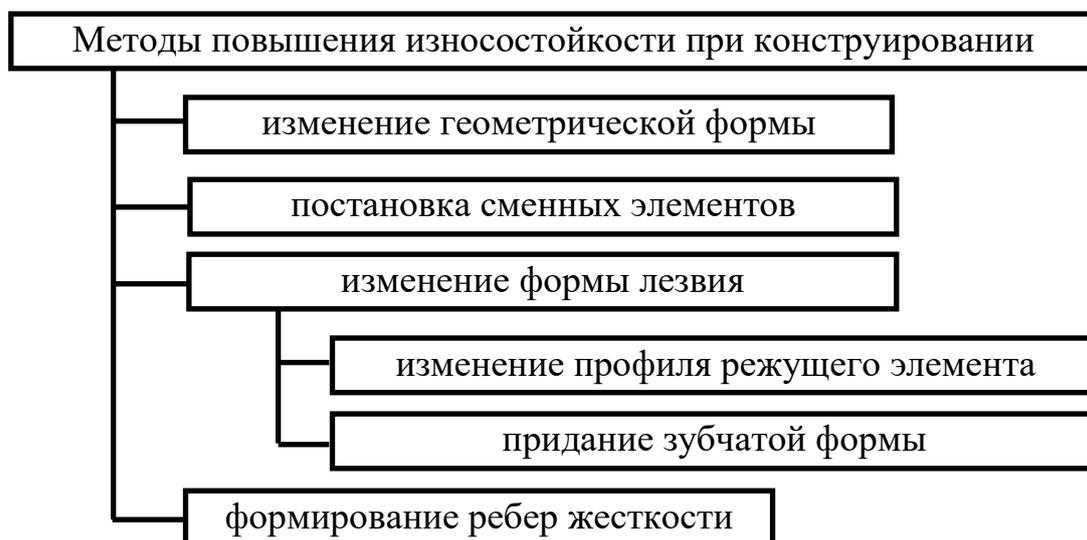
Рисунок 1.2 – Методы упрочнения, основанные на изменении конфигурации
