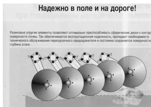
Рисунок 6.3 – Копирование рельефа и обход препятствия дисками с эластичными предохранительными элементами
