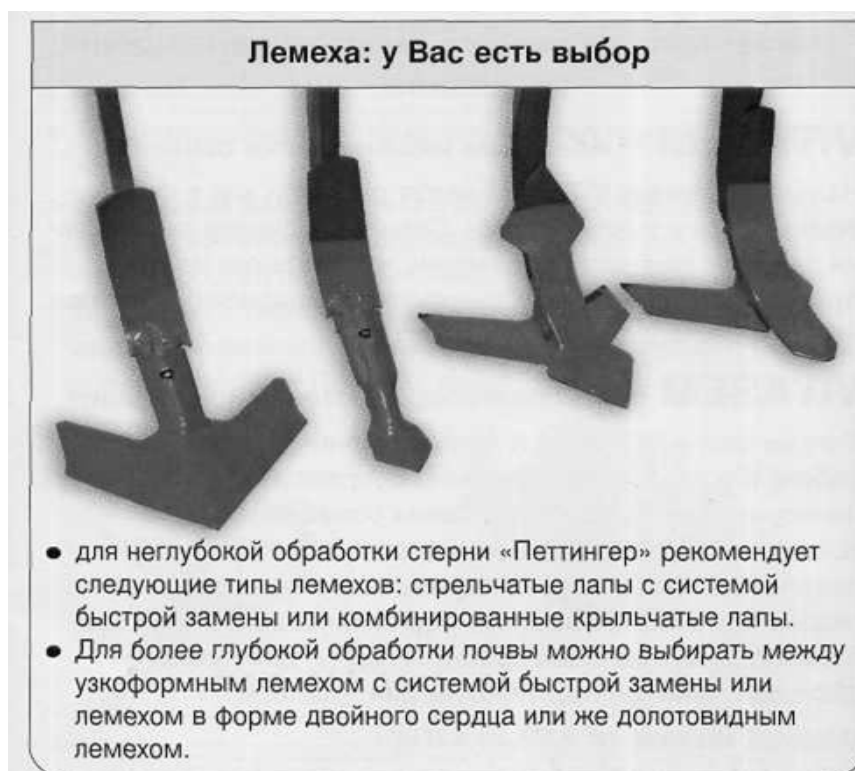
Рисунок 6.28 – Типы рабочих органов паровых культиваторов
