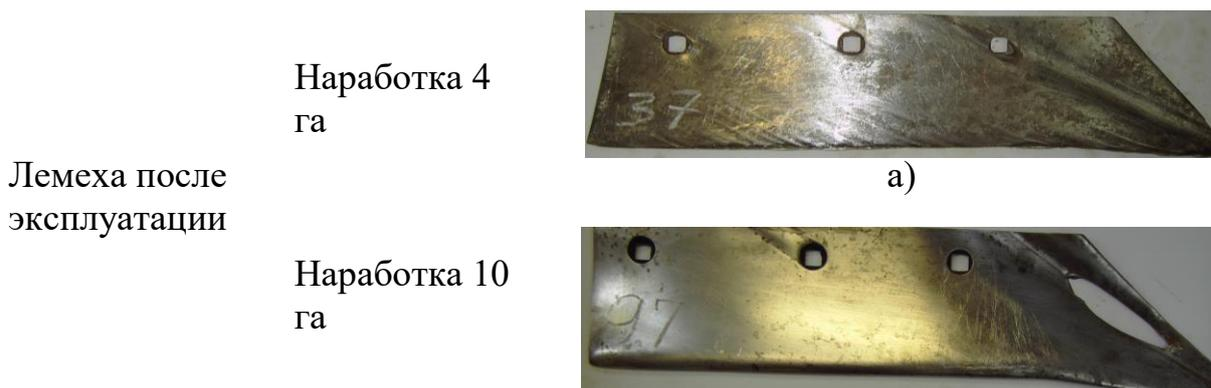
Рисунок 30 – Дефекты лемеха: а) – абразивный износ рабочей поверхности (начальный период образования лучевидного износа), б) – сквозное протирание
