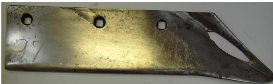
Рисунок 26 – Лучевидный износ носка лемеха, осложненный сквозным протираем
