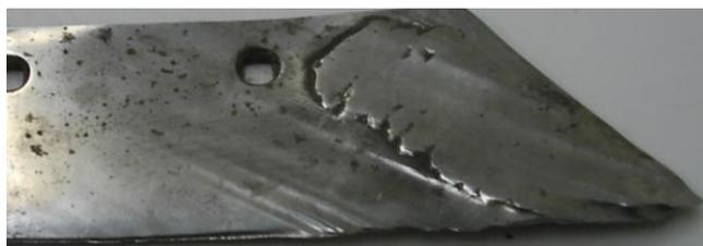
Рисунок 33 – Восстановленный лемех после эксплуатации
