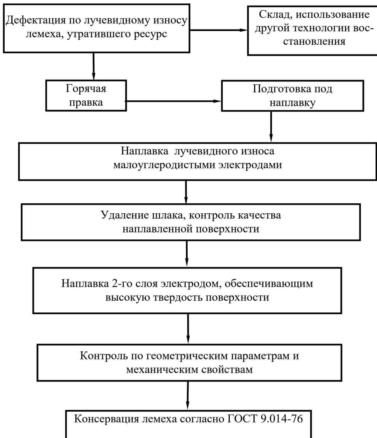
Рисунок 29 – Схема общего технологического процесса восстановления лемеха
