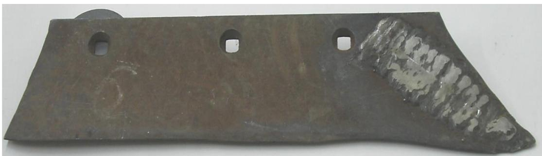
Рисунок 32 – Наплавка второго слоя электродом Т-590
