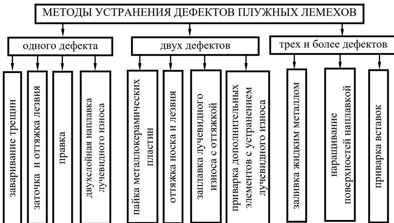
Рисунок 27 – Схема методов устранения дефектов плужных лемехов
