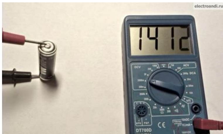
Рисунок 2.10 - Измерение постоянного напряжения
