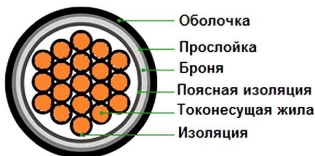
Рисунок 1.31 - Конструктивные особенности контрольных кабелей
