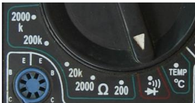
Рисунок 2.14 - Мультиметр в режиме «прозвонки»
