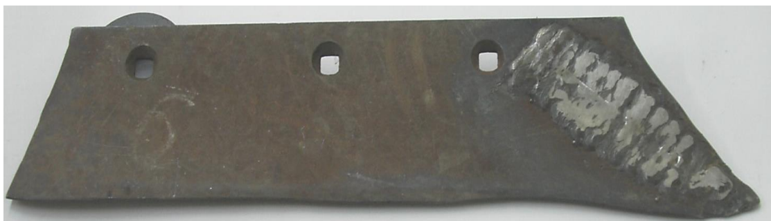
Рисунок 32 – Наплавка второго слоя электродом Т-590
