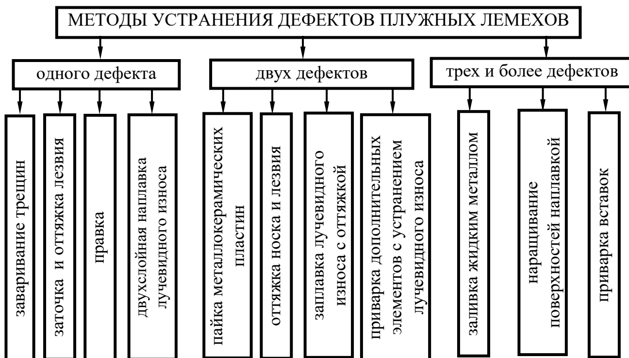
Рисунок 27 – Схема методов устранения дефектов плужных лемехов
