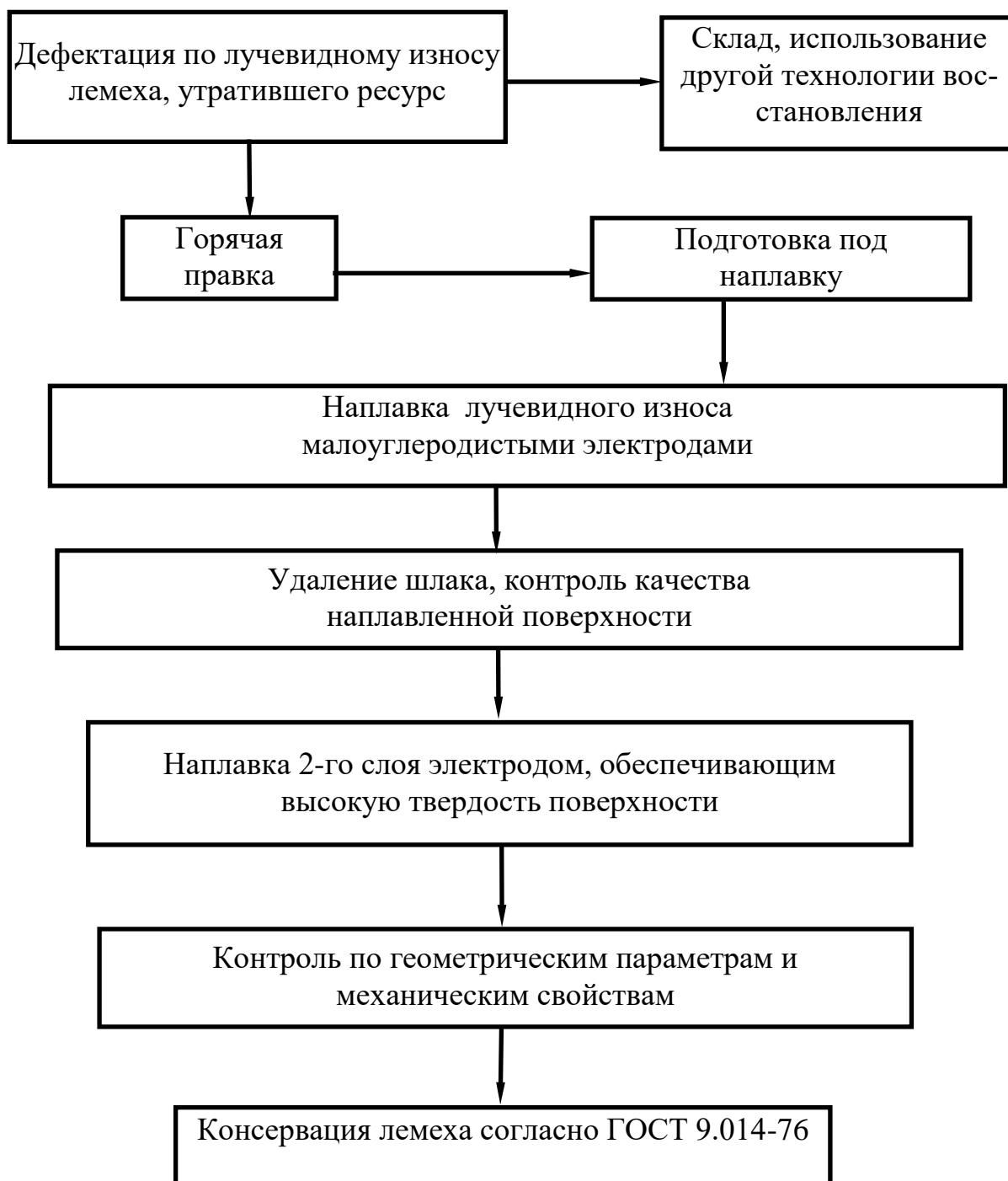
Рисунок 29 – Схема общего технологического процесса восстановления лемеха
