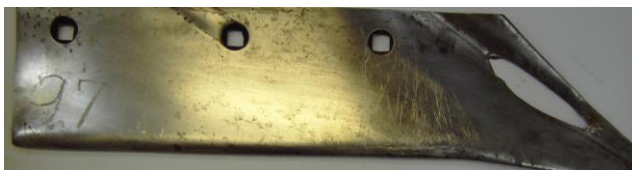
Рисунок 30 – Дефекты лемеха: а) – абразивный износ рабочей поверхности (начальный период образования лучевидного износа), б) – сквозное протирание
