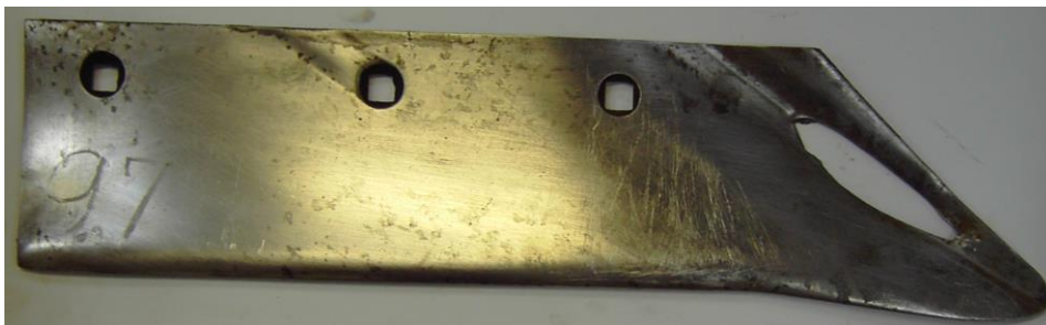
Рисунок 26 – Лучевидный износ носка лемеха, осложненный сквозным протираем
