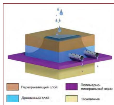
Рисунок 2 – Схема действия полимерно-минерального противофильтрационного экрана основания полигона
