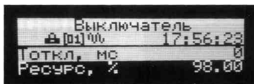
Рисунок 3 - Ресурс выключателя на экране устройства БМРЗ
