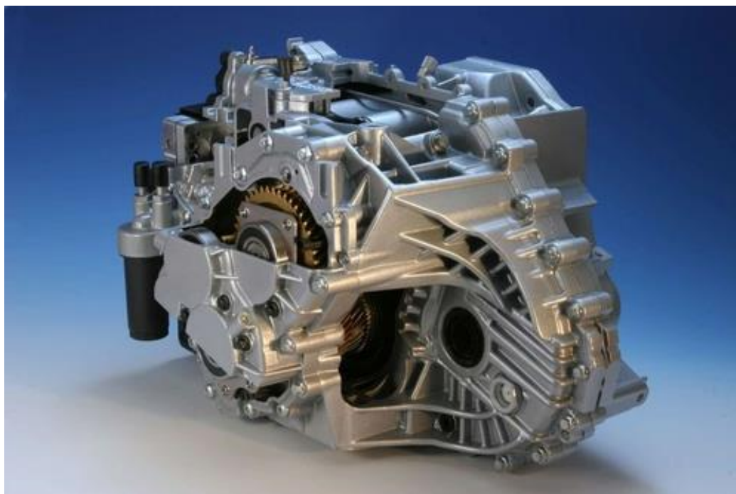
Рисунок 8 - Робот-коробка от Форд — PowerShift
