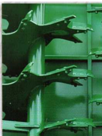
Рисунок 29 – Разбрасывающий рабочий орган машины МТУ-11
