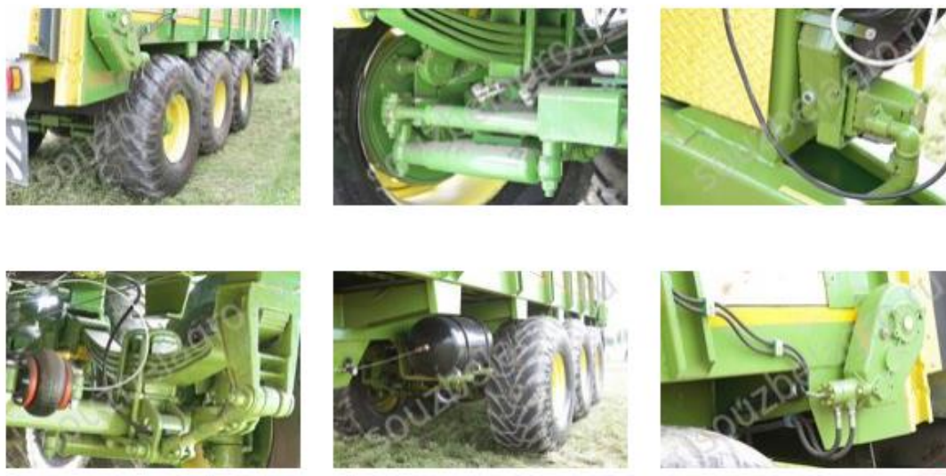
Рисунок 4 - Вид конструктивных особенностей разбрасывателя РОУМ-20
