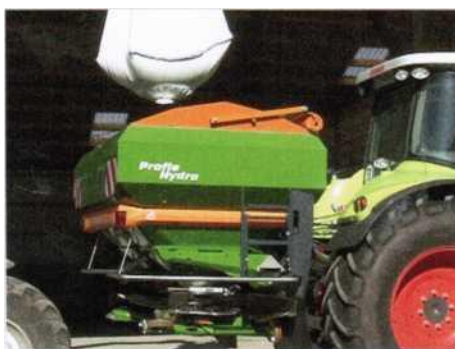
Рисунок 77 – Распределитель ZA-TS 2000 с гидравлическим защитным тентом
