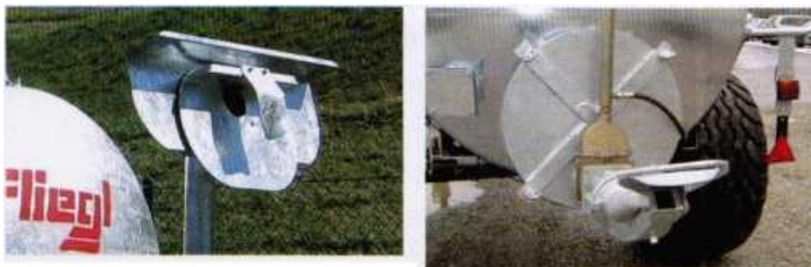
Рисунок 95 - Распределители органических удобрений жижестерн фирмы «Fliegl»: а – эжекторный; б – механический; в – комбинированный
