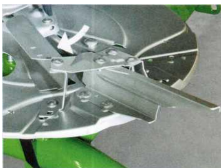
Рисунок 76 - Распределительное устройство TS с интегрированной системой пограничного распределения AutoTS с электромеханическим управлением
