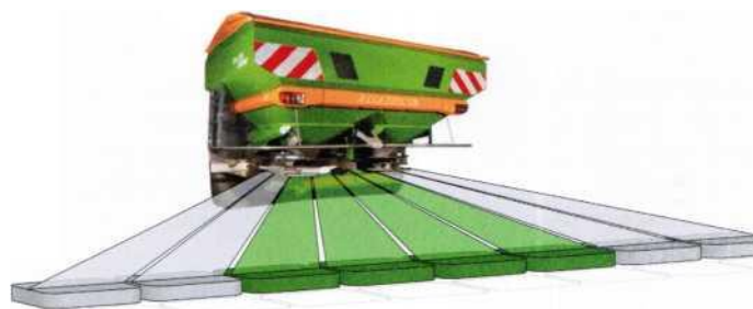
Рисунок 80 - 8-микратное переключение секций на ZA-TS Hydro с гидравлическим приводом распределительных дисков
