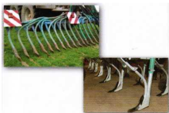
Рисунок 24 – Рабочие органы адаптеров АЖУ-12 и АВУ-6
