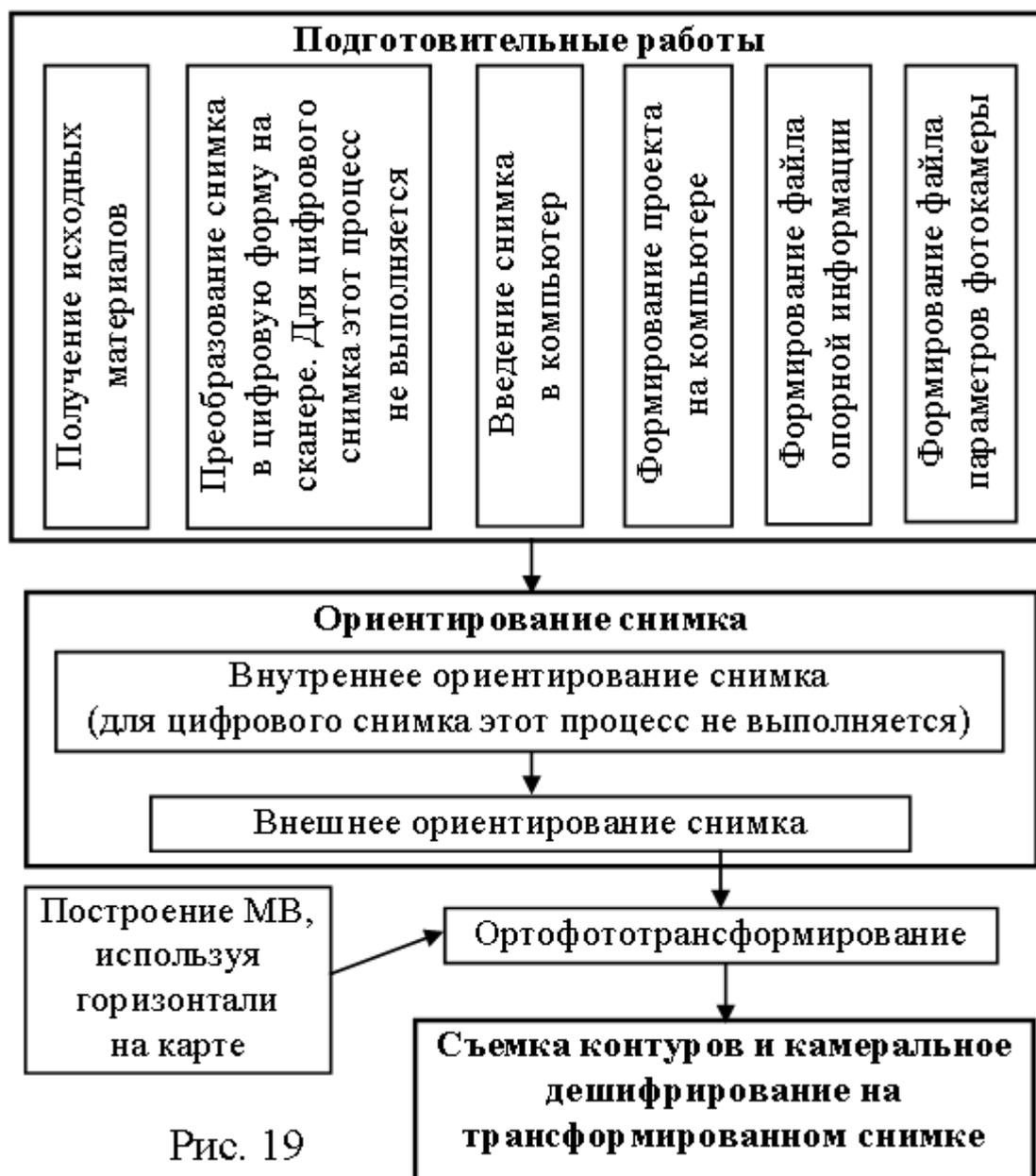
На рис. 19 приведена технологическая схема фотограмметрической обработки одиночного снимка, в результате которой можно создать фотоплан и выполнить по нему съёмку (векторизацию) контуров. Такой вариант возможен для открытой равнинно-всхолмленной местности при наличии населённых пунктов с малоэтажной застройкой.
