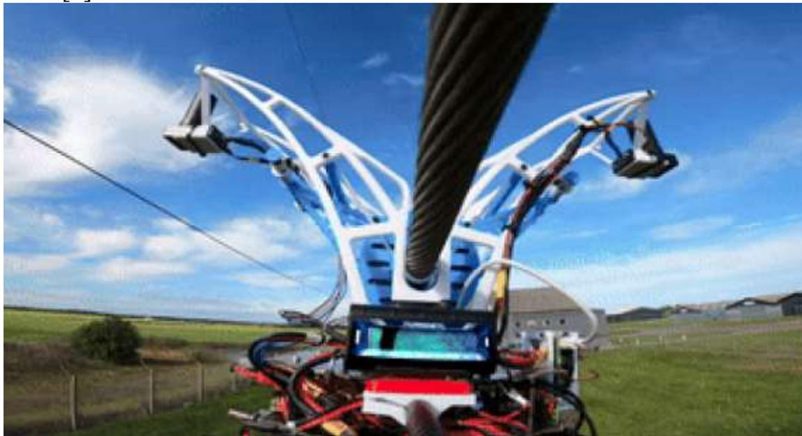
Рисунок 1 – Подключение квадрокоптера к линии электропередач
