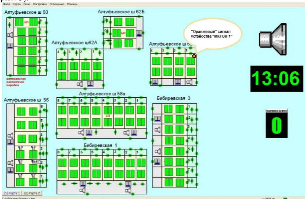
Рисунок 3 - Режим «Требуется проведение ТО» устройства «МКТОЛ-1» (отображение на экране АРМ диспетчера ОДС)
