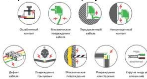
Рисунок 1 - Типовые причины появления дугового пробоя в электросетях
