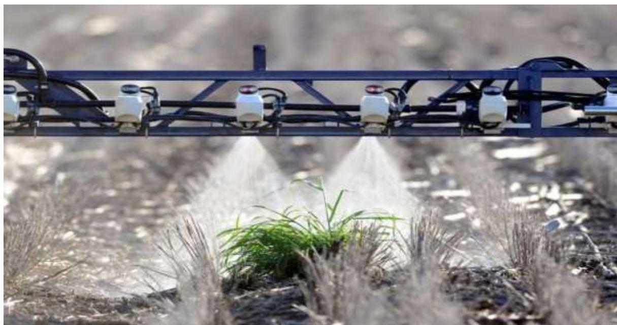
Рисунок 1 - Использование системы WeedSeeker
