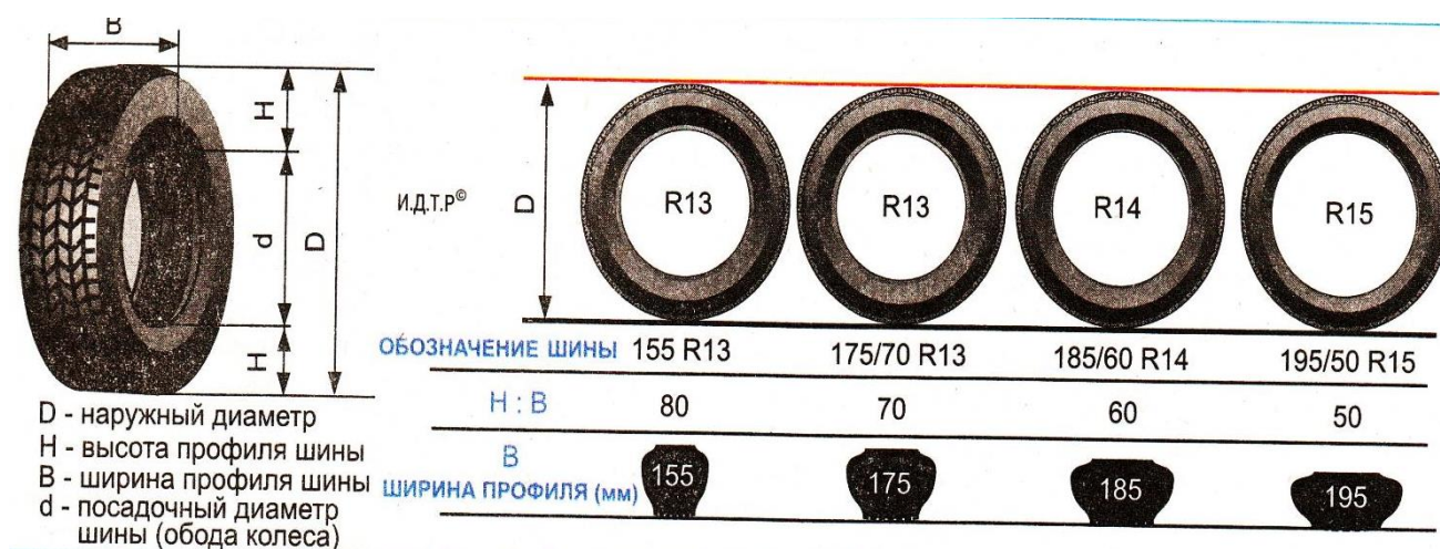
Рисунок 5.27 – Геометрические параметры и маркировки шин
