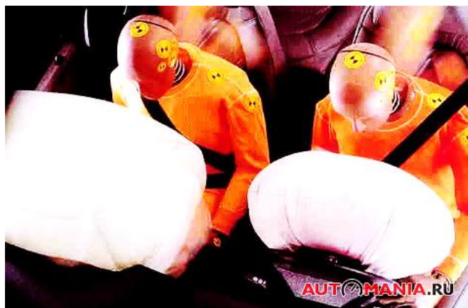
Рисунок 5.15 – Работа фронтальных подушек в аварийной ситуации
