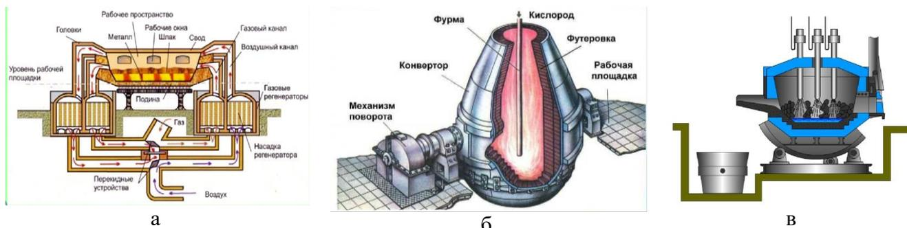
Рисунок 2.2 – Сталеплавильные агрегаты
