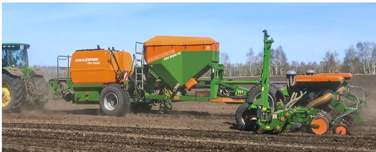
Рисунок 4 - Агрегат FDC-6000 с EDX 9000-ТС для посева подсолнечника и кукурузы одновременно с внесением жидких-КАС и твердых минеральных удобрений
