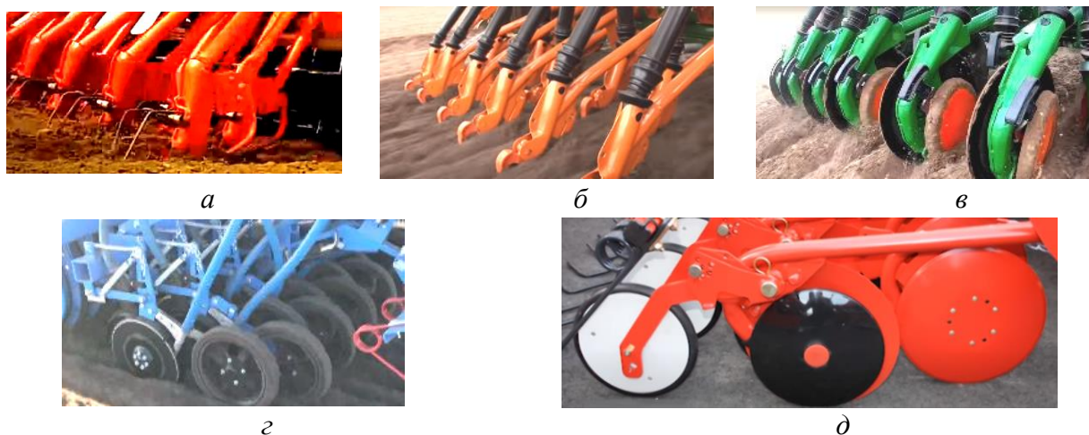
Рисунок 3 – Конструкции сошников для посева льна зарубежных сеялок: a – KUNH Logiseme M3000; б, в – AMAZONE D9; г – LEMKEN Solitair 9; д – KVERNELAND Accord
