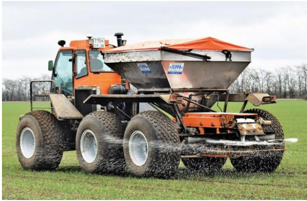
Рисунок 4 - Агрегаты фирмы «Пегас-Агро» для агрохимических работ в земледелии: а) - разбрасыватель сыпучих минеральных удобрений «Туман-2», б)-Вентиляторный опрыскиватель «Туман» для жидких инсектицидов
