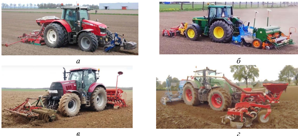
Рисунок 4 – Комбинированные машинно-тракторные агрегаты, которые применяются для посева льна и других культур: а – MASSEY FERGUSON 6614 + Kverneland Accord с приспособлением для усадки почвы на передней навеске (Нидерланды); б – JOHN DEERE 6610 + Amazone D9-30 с катковой приставкой на передней навеске (Нидерланды); в – CASE PUMA 145 + KUHN Logiseme M3000 с комбинированным почвообрабатывающим агрегатом на передней навеске (Франция); г – FENDT 939 + Lemken Solitair 9 с переоборудованной на переднюю навеску сеялку (Франция)
