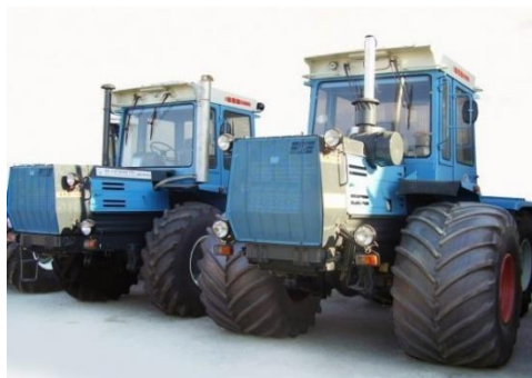
Рисунок 1 - Трактор ХТЗ-150К на штатных одинарных шинах (слева) и на широкопрофильных шинах низкого давления (справа)
