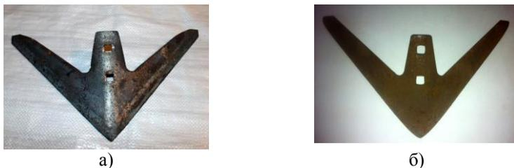
Рисунок 1 – Фотография культиваторной лапы КПС – 4 330. а) – в состоянии поставки; б) – после эксплуатации
