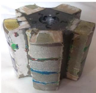
Рисунок 1 – Приспособление с 20-ю композитами различных составов
