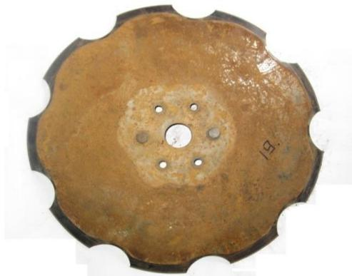
Рисунок 3 – Подготовка дисков к измерениям
