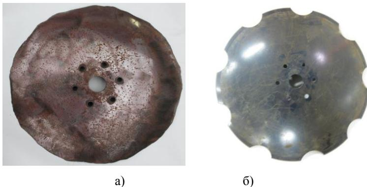
Рисунок 1 – Диск после истирания (а) и в состоянии поставки (б)
