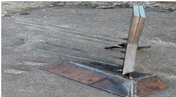
Рисунок 2 - Плужный корпус
