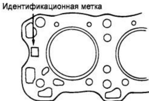
Рисунок 14 – Идентификационная метка прокладки головки блока цилиндров
