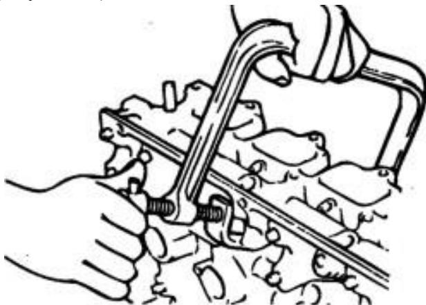
Рисунок 13 – Установка сухарей
