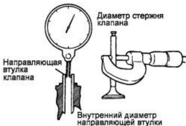
Рисунок 2 – Проверка зазора между направляющей клапана и стержнем клапана
