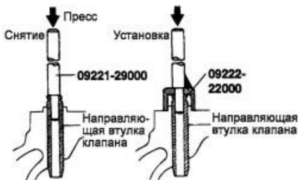
Рисунок 7 – Схема замены направляющей втулки клапана
