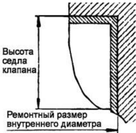
Рисунок 10 – Схема расточки отверстия
