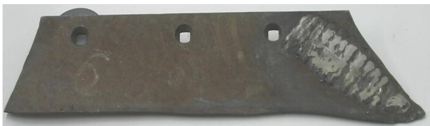
Рисунок 31 – Наплавка второго слоя электродом Т-590
