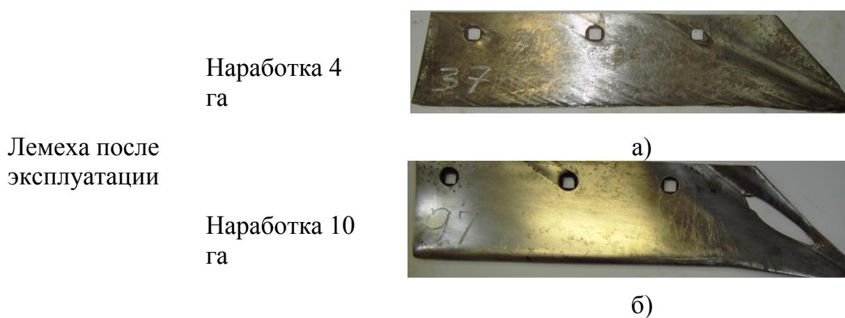
Рисунок 29 – Дефекты лемеха: а) – абразивный износ рабочей поверхности (начальный период образования лучевидного износа), б) – сквозное протирание
