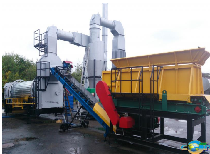
Рисунок 2 – Установка для утилизации замазученных грунтов
