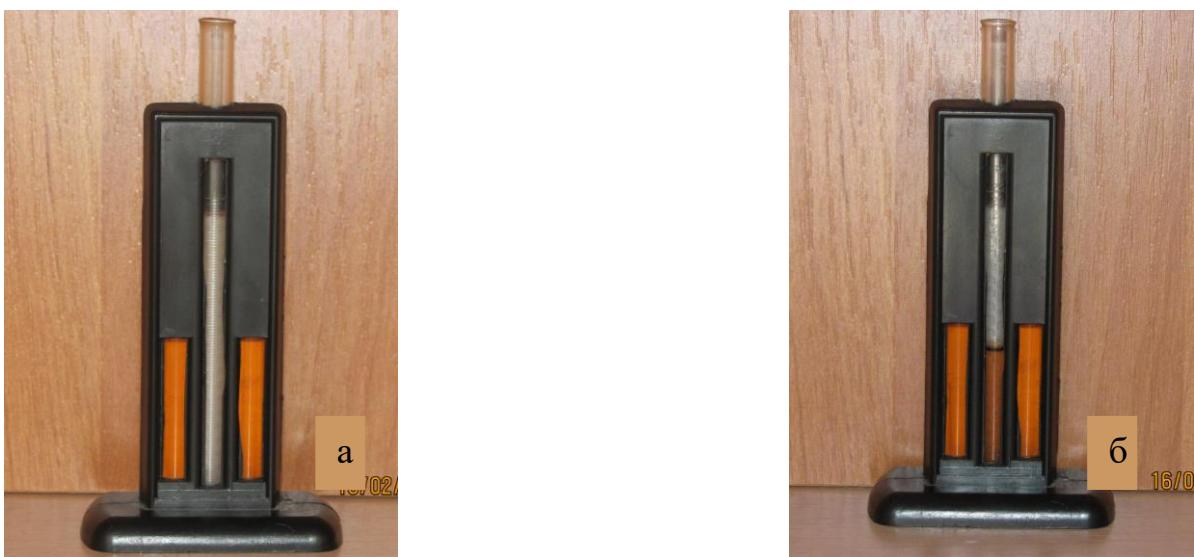
Рис. 11. Гемометр Сали (а – пустой, б – заполненный)
