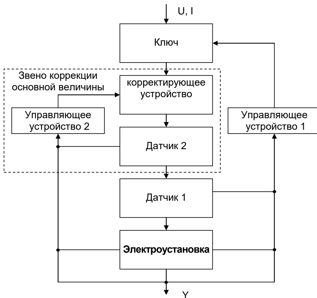
Рисунок 5. Схема комбинированного устройства с коррекцией основной контролируемой величины
