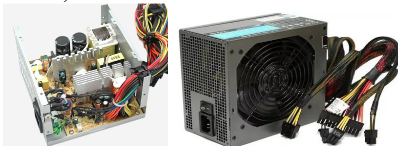
Рис. 72. Внешний и внутренний вид блока питания
