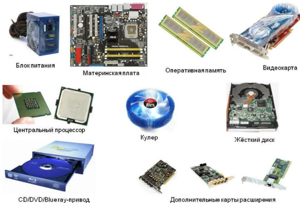
Рис. 3. Основные компоненты системного блока ПК
