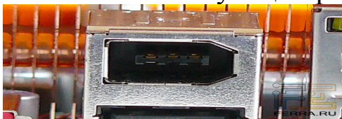
Рис. 32. Разъем FireWire и Контроллер IEEE-1394 (FireWire) на материнской плате
