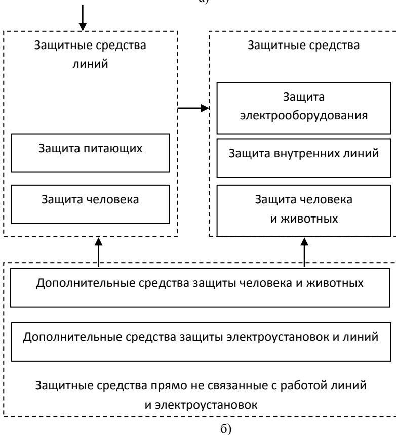
Рисунок 1. Система защит производственного помещения (а) и обобщенная структура защит производственного помещения (б)
