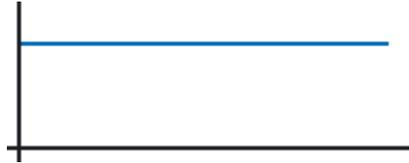
Gleichstrom fließt ständig in einer Richtung. Jeder Leiter setzt dem elektrischen Strom einen Widerstand (R) entgegen (Ohm ist die Einheit des Widerstandes). Der Ohm'sche Widerstand ist die Drahtlänge direkt und dem Drahtquerschnitt umgekehrt proportional; von Einfluss ist sich die Leitfähigkeit des Materials (Kupfer sehr gut, Eisen schlecht).
