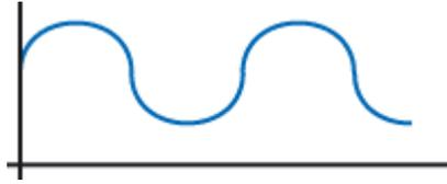
Ein Mischstrom entsteht rein physikalisch durch Summation, also Zusammenschalten, beider Stromanteile. In der Praxis entsteht Mischstrom beispielsweise durch Gleichrichtung eines Wechselstroms ohne Anwendung von Glättungskondensatoren oder Glättungsinduktoren. Auch elektromagnetische Gleichstromgeneratoren erzeugen einen Gleichstrom, dessen Stärke mehr oder minder mit der Drehzahl der Maschine schwankt und somit also einen Mischstrom darstellt.
