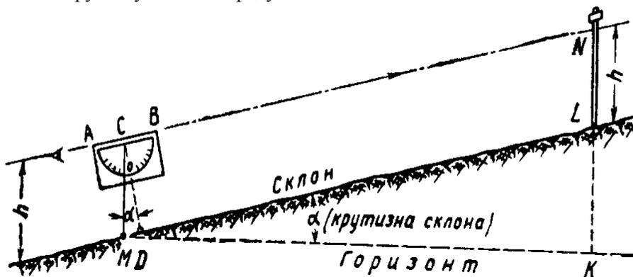
Рис. 1. Определение крутизны склона эклиметром
