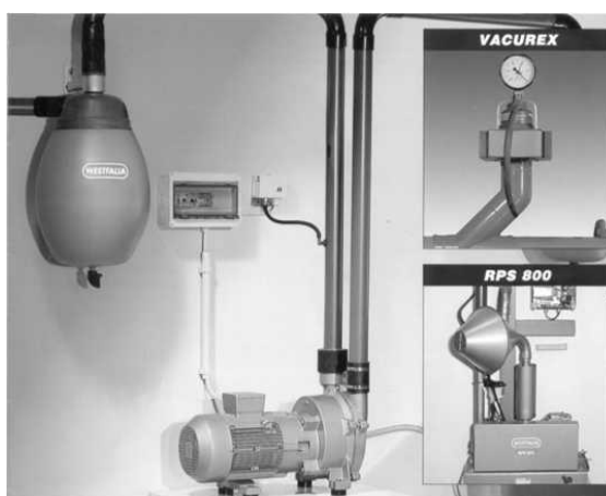
Рисунок 1.11 - Общий вид вакуумной установки фирмы «Westfalia Landtechnik» с рециркуляционной системой смазки
