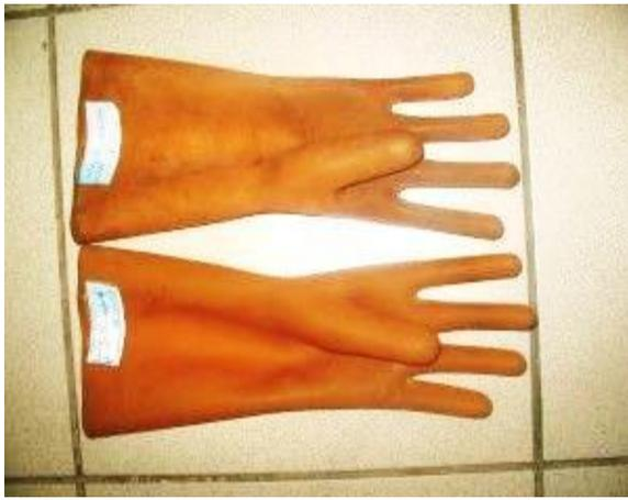
Рис. 2. Диэлектрические перчатки
