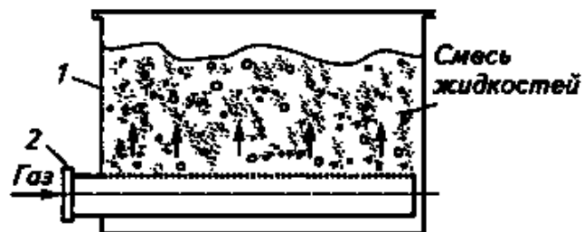
Рис. 7. Схема пневматического смесителя (барботера)
