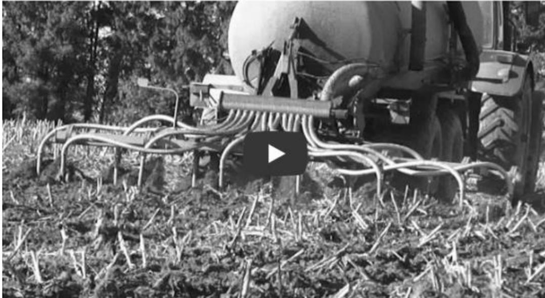
Рисунок 8.12 – Машина для внесения жидких органических удобрений МЖУ-20.
