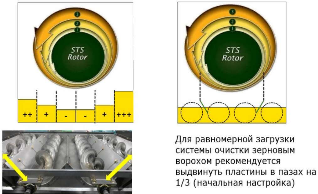
Рисунок 5.9 – «Комбайны серии S – Система очистки»
