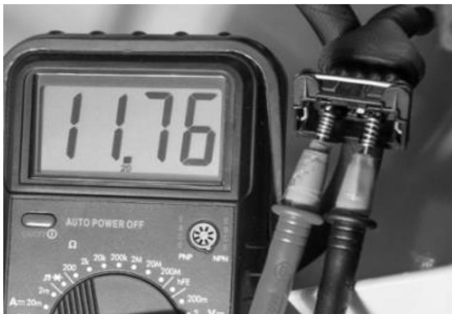
**Рис. 3.4. Проверка напряжения на разъеме секции EHS**
