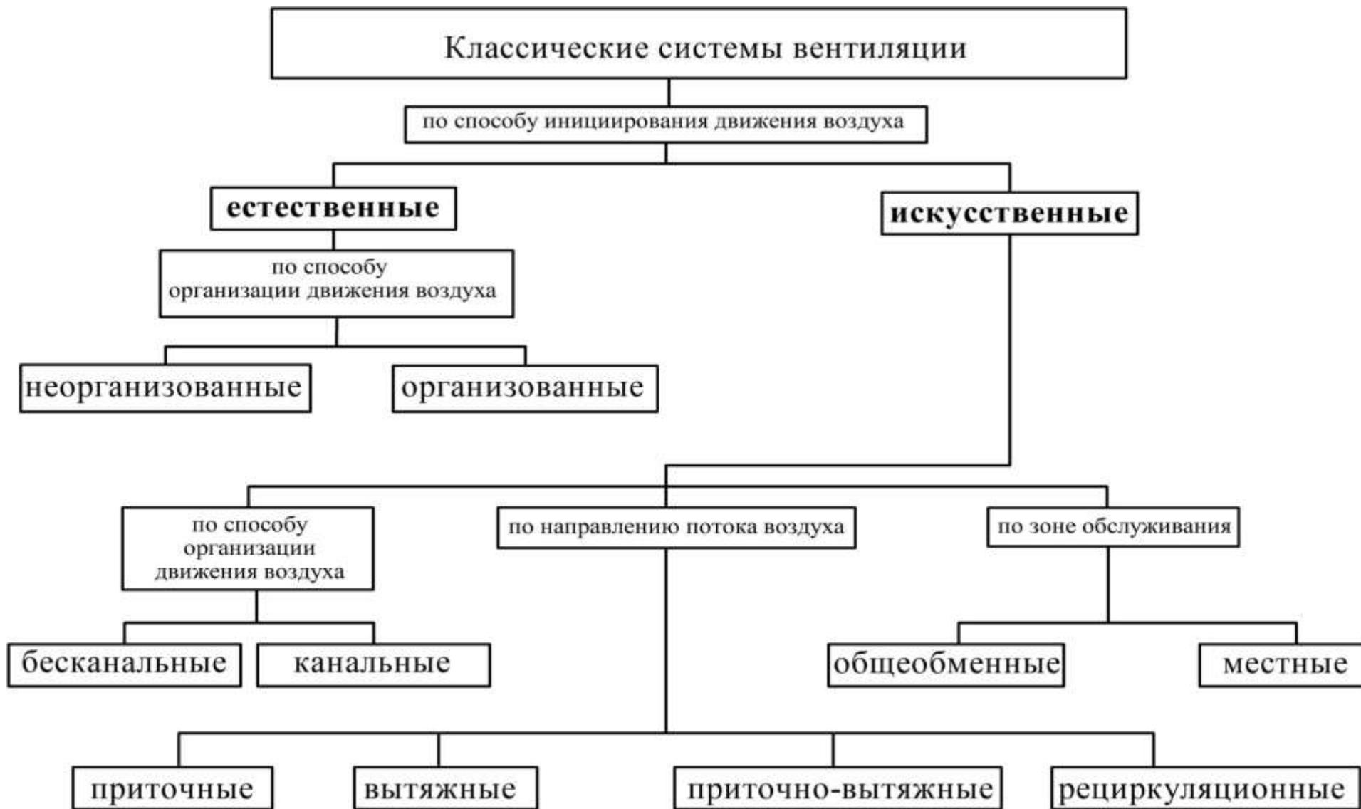
*Рис. 4.* Классификация существующих систем вентиляции
