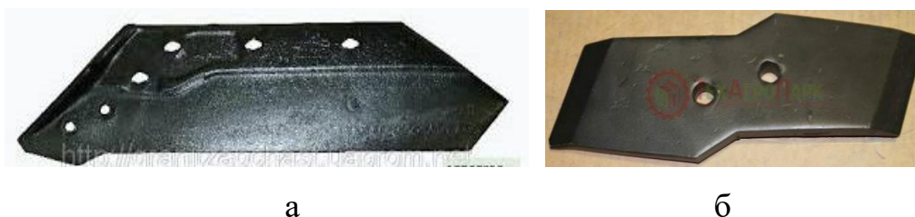
Рисунок 8 – а – остов лемеха фирмы «Кун»; б – долото фирмы «Кун»
