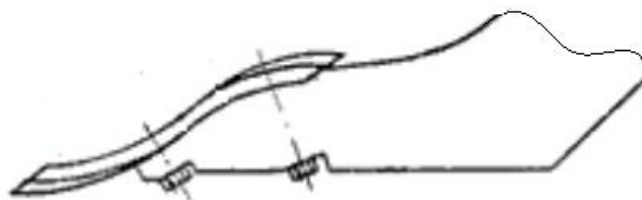
Рисунок 11 – Рабочий орган с обратным S – образным долотом
