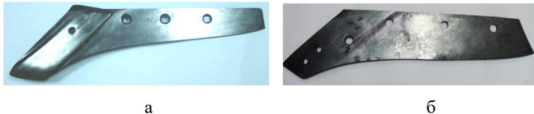
Рисунок 5 – Характерный износ режуще-лезвийной части импортных лемехов: а - лемех фирмы «Квернеланд Групп»; б - лемех фирмы «Беллота»
