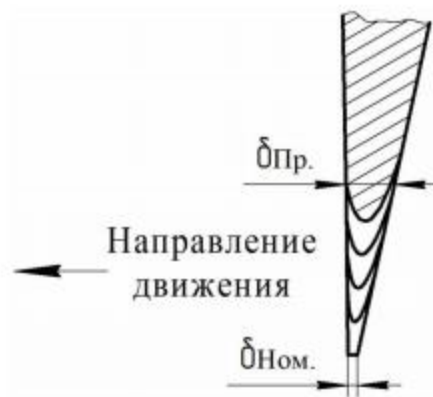
Рисунок 2 - Динамика износа лезвия дискового рабочего органа
