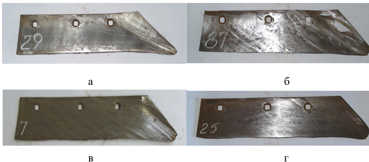
Рисунок 1 – Виды износа лемеха:
