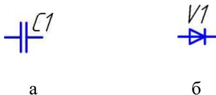
Рисунок 4 - Позиционные обозначения элементов электрических схем
