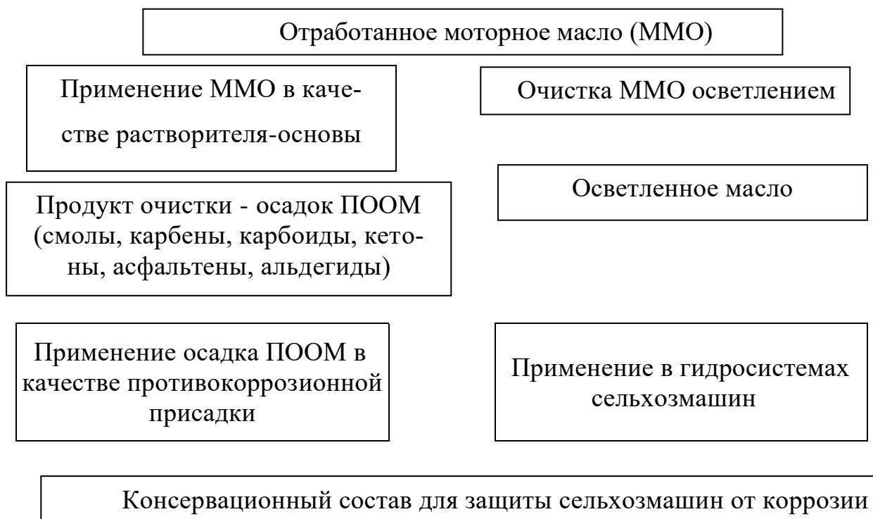
Рисунок 10 - Схема использования отработанных масел и продуктов их очистки в качестве консервационных материалов для защиты от атмосферной коррозии
