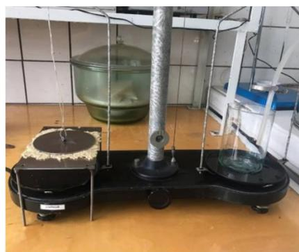
Рис. 2 – Определение липкости
