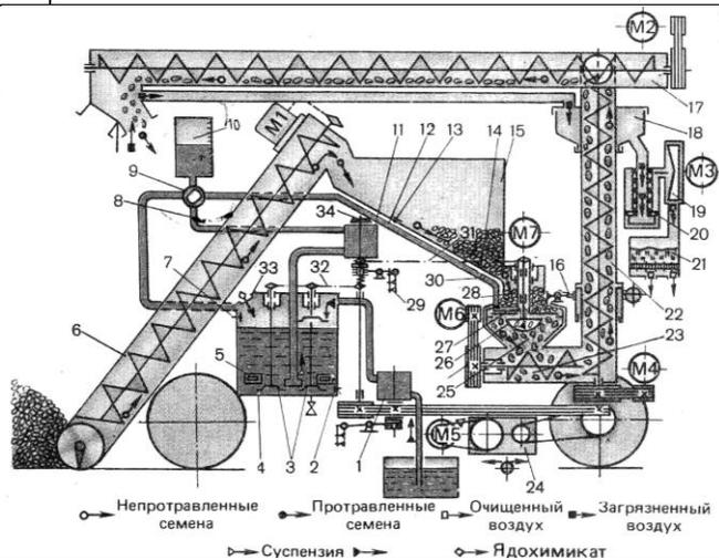
Рисунок 1 – Схема рабочего процесса протравливателя ПС-10А
