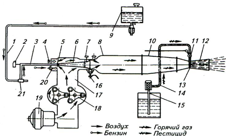
Рисунок 2 – Схема рабочего процесса аэрозольного генератора АГ-УД-2
