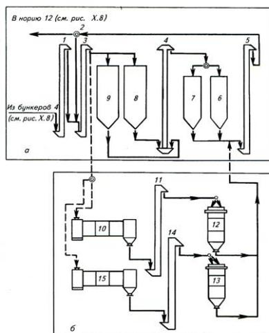
Рисунок 6 – Технологическая схема сушильного отделения комплекса
