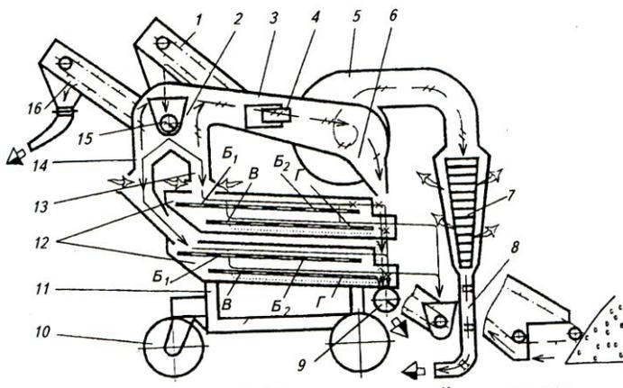
Рисунок 1 – Схема рабочего процесса самоходной воздушно-решетной машины ОВС-25
