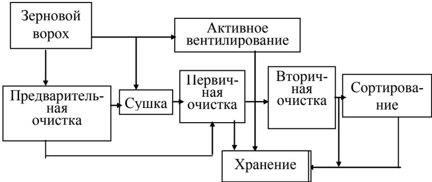
Рисунок 5 - Схема последовательности процессов послеуборочной обработки урожая
