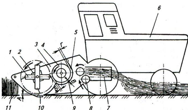
Рисунок 4 – Схема рабочего процесса косилки - плющилки КПС-5Б
