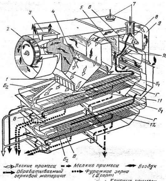
Рисунок 6 - Технологическая схема работы стационарной зерноочистительной машины ЗВС-20
