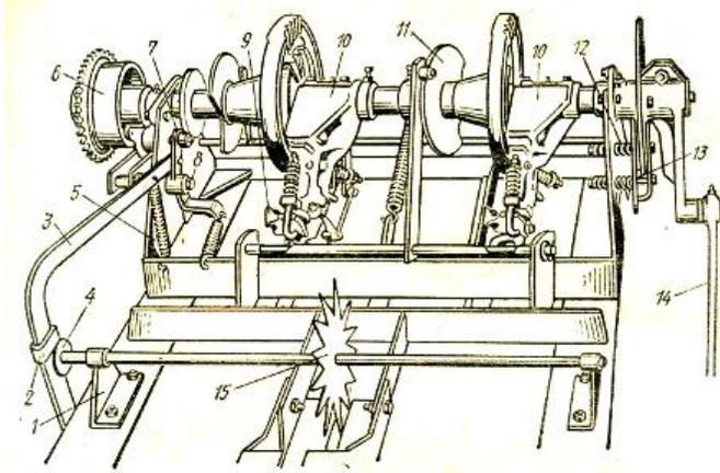
Рисунок 2 – Узловязатель пресс-подборщика ППЛ-Ф-1,6
