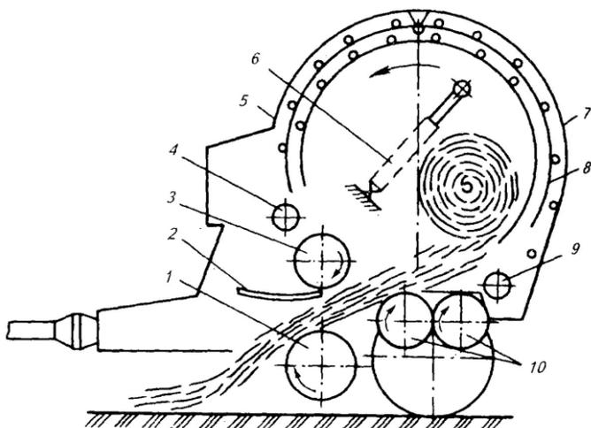
Рисунок 4 – Схема рабочего процесса пресс-подборщика ПР-Ф-750
