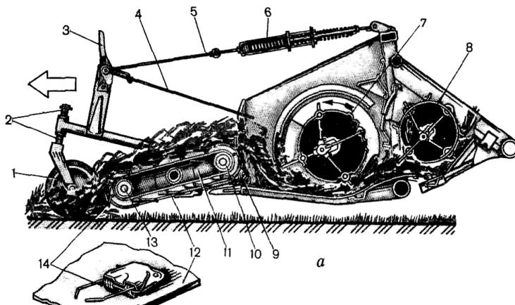
Рисунок 5– Схема подборщика
