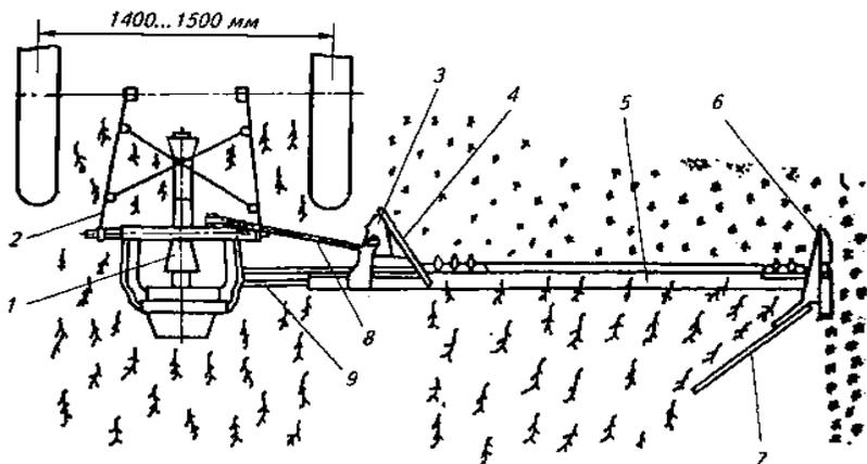
Рисунок 1 – Схема рабочего процесса косилки КС-Ф-2,1
