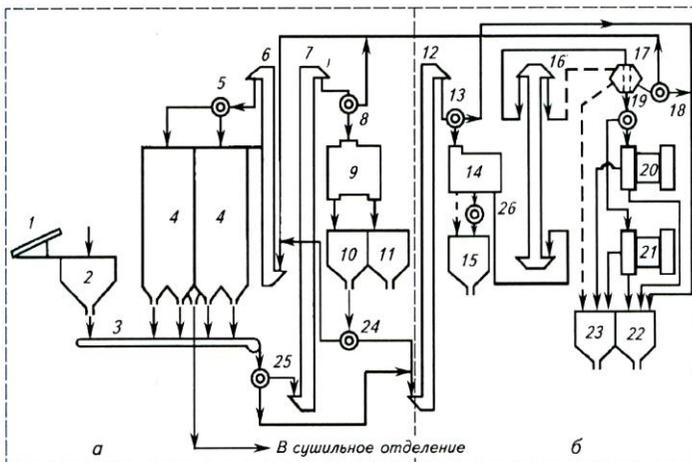
Рисунок 5 – Технологическая схема зерноочистительного агрегата ЗАВ - 25
