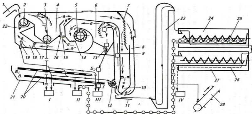
Рисунок 4 – Схема рабочего процесса семяочистительной машины МС-4,5
