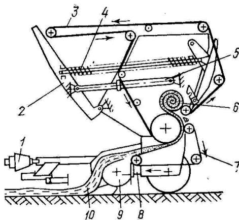
Рисунок 3 – Схема рабочего процесса пресс-подборщика ПРП-1,6
