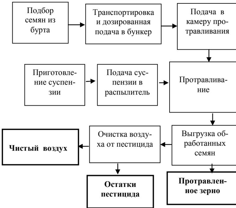
Рисунок 3 - Структурная схема технологического процесса протравливателя ПС-10А
