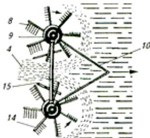
Рисунок 6 – Схема работы роторных граблей ГВР-6Б
