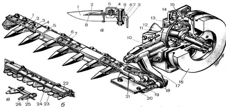
Рисунок 1 – Режущий аппарат комбайна ДОН – 1500Б
